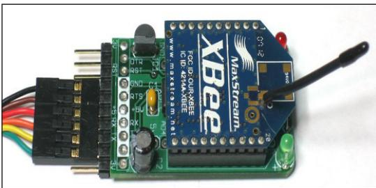
**Fig. 1:** Zigbee module
